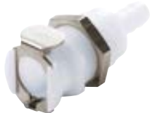
Быстроразъёмные соединения (гнездового типа), номинальный диаметр отверстия 6,4 мм, для монтажа на корпус с обычными наконечниками
