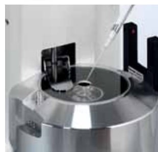
Эргономичность и быстрота Интегрированный ИК-сенсор открывает или закрывает окно антииспарителя, когда наконечник пипетки проходит через «лучевой барьер».
